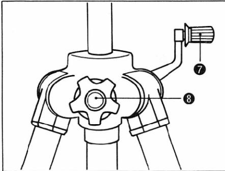
エレベーターストップ⑧をゆるめてクランクハンドル⑦を回して高さを調節します。高さが決まったら確実にエレベーターストップ⑧を固定させてください。
