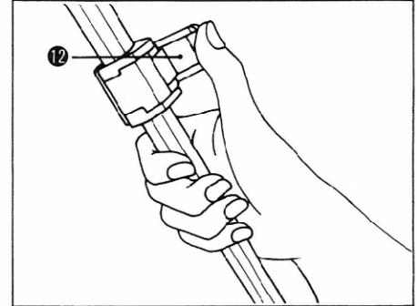
脚の長さを調節する時は右手の親指で脚固定レバー⑫をおこすようにしてロックをはずし、上の段の脚から順に伸ばしてください。縮めるときは逆に下の段の脚からしまってください。脚の長さが決まったらレバーを確実におさえてロックしてください。
