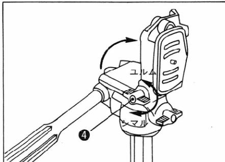
カメラ台ストップ④をゆるめカメラ台を右側へ起すとカメラのたて位置撮影ができます。ビデオボス⑭はスチールカメラの取り付けの場合は下にへこみます。
