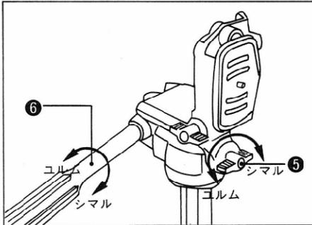
パンハンドル⑥をゆるめるとカメラのたて方向が動き、パンストップ⑤をゆるめるとカメラの左右方向が動きます。撮影時は各ストップをしっかりと締めてシャッターを切ってください。尚、雲台は三脚本体から取り外すことはできません。
