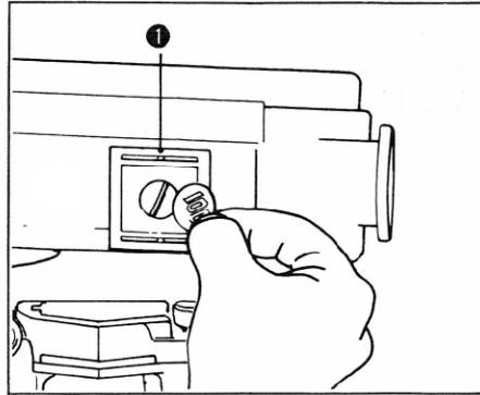
クイックシュー①のカメラネジをカメラの底部のネジ穴に合わせ、コインなどでしっかり固定させます。クイックシュー①を雲台のプレートに横からすべり込ませるようにしながらさし込み、クイックシュー固定レバー②を矢印のLOCKの方向に回してしっかり固定させます。はずす時はカメラを片手でしっかりつかみ、クイックシュー固定レバー②をゆるめ、クイックシュー①をつけたまま横へすべらせながらはずします。カメラを落さないように注意してください。
