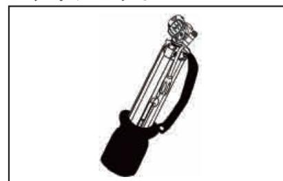
三脚を持ち運ぶ際は、付属のレグポシェットを使うと便利です。上図のように三脚の脚部をポシェットに入れます。※必ず脚部が下になるようにして持ち運んで下さい。雲台が下になるとポシェットが抜けてしまい危険です。
