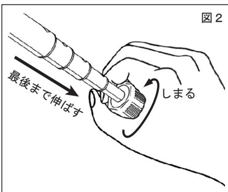
脚を伸ばすには脚先端の石突を握ってゆるむ方向(図①)に回します。その際「カクツカクツ」と4回抵抗があります。その後脚を最後まで引き出し、再度石突をしめる方向(図②)にキツめに回し脚をロックします。脚を縮めるときは逆の手順を行ってください。
