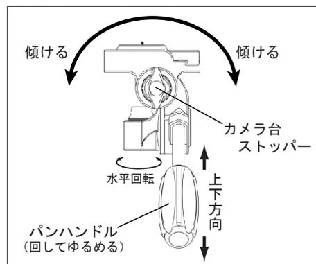
パンハンドルを回しゆるめると、カメラの上下動(ティルト)操作と同時に左右水平回転(パン)操作ができます。カメラ台ストッパーをゆるめると、左右両方向へカメラを傾ける(サイドティルト)操作ができます(必ずカメラを手で支えながら操作してください)。
