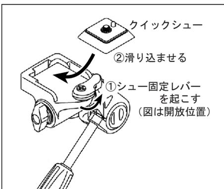
シュー固定レバーを開放位置側に起こしながら、クイックシューをレバー側から斜めに滑らせるように取り付け、手でレバーをしっかりと締めます。外すときは逆の手順を行ってください。
