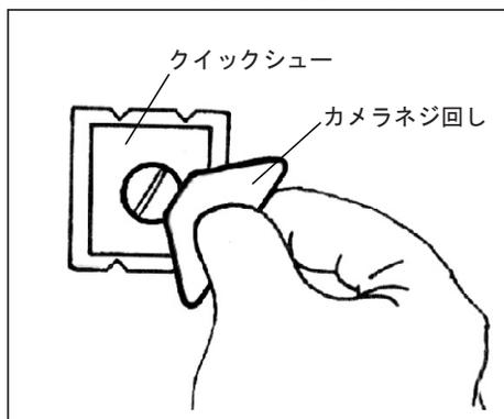
カメラ側のネジ穴にクイックシューのカメラネジを合わせ、付属のカメラネジ回しでしっかりと締め付けます。カメラネジ回しを紛失してしまった場合は、コイン等で代用してください。
