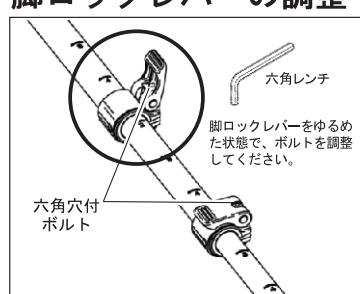
長期間の使用等で、脚ロックがゆるくなったり場合には、上図の六角穴付ボルトを付属の六角レンチでしめて調整します。六角穴付ボルトをしめすぎると、脚の伸縮がしづくなりりますのでご注意ください。
