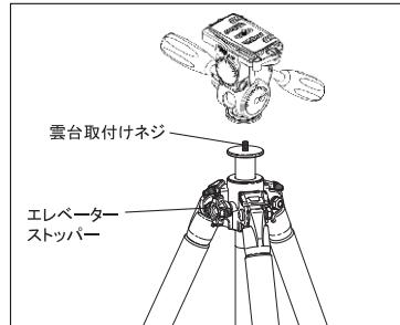
雲台を交換するには、雲台の全てのストッパー やハンドル、エレベーターストップバーをしっかりとしめ、雲台全体を反時計方向に回すと外れます。他の雲台に交換することができます。※雲台取り付けネジはUNC1/4(細ネジ)サイズです。
