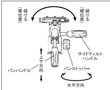
パンハンドルを反時計方向に回しゆるめるると、カメラの上下方向が変えられます。サイドティルトハンドルをゆるめるると、カメラの傾きが変えられます。パンストップバーをゆるめるると、カメラを水平方向へ回転させることができます。必要な位置で各々をしめて撮影します。
