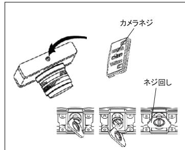
カメラのネジ穴とカメラネジを確実に合わせ、クイックシュー裏面に付いているネジ回しでしっかりとしめ付けます（ネジ回しを無くしてしまった場合は、コイン等で代用してください）。
