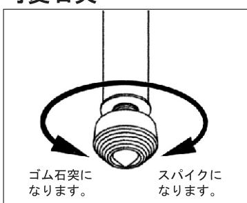
脚先端部は可変石突になっています。設置する地面の状況に応じて先端部を回し、ゴム石突とスパイクを変換してご使用ください。なお携帯時は危険ですので、必ずゴム石突にしてください。
