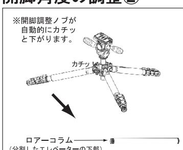
② ローポジションにした脚をゆっくり閉じていくと、開脚調整ノブが自動的に一段下がります。この位置がセミローポジションとなります。
