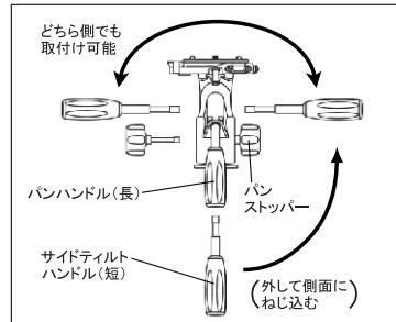
サイドティルトハンドルをパンハンドルからはずし、本体側面の穴にねじ込みます。※サイドティルトハンドルとパンストップバーは左右どちらにも取付け可能ですが、同じ側面に取付けてください。それぞれ違う側面に取付けると、カメラを縦位置にしながら上方に向けることはできません。
