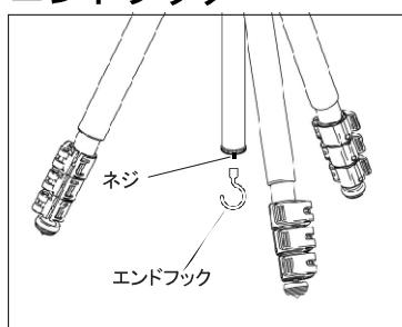
付属のエンドフックは、上図のようにエレベータ下部のネジに取り付けて使用します。カーボンバグ等を吊り下げ、安定性を確保します。吊り下げるバグが風にあおられるときの原因になりますので、ベルトは出来るだけ短くして吊り下げてください。
