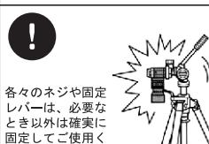
各々のネジや固定レバーは、必要なとき以外は確実に固定してご使用ください。ネジや固定レバーがゆるんでいると、三脚の転倒やカメラ破損の原因となります。
