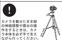
カメラを載せたまま脚の伸縮調整や雲台の操作をするときは、カメラ本体を必ず手で支えながら行ってください。三脚やカメラが不意に動き、カメラを破損したり手を三脚にはさみケガをする恐れがあります。
