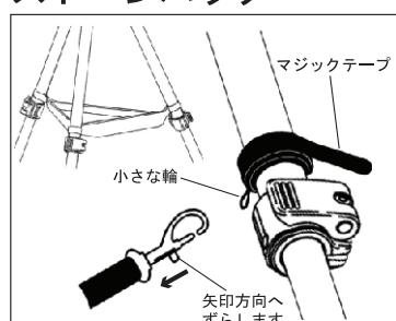
風の強い場所では、重し入れとしてストーンバッグをお使いください。バンドの小さな輪ができる方を内側にして、上図の部分にマジックテープできつく巻きつけます（三箇所とも）。その輪にストーンバッグのフックを引っかけて使用します。
