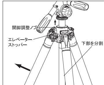
① 脚を折りたたんだ状態で、開脚調整ノブを力ちつと止まる所まで引き上げ、脚をいっぱいに開くとローポジションとなります（エレベーターは、ストップバーをしめてから下部を回すと分割できます）。
