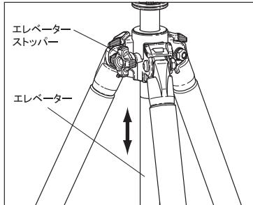
エレベーターストップバーを反時計方向にまわしゆるめるると、エレベーターの昇降が可能です。必要な位置でストップバーをしめて固定します（エレベーターの操作時は必ず機材を手で持ちながら行ってください）。
