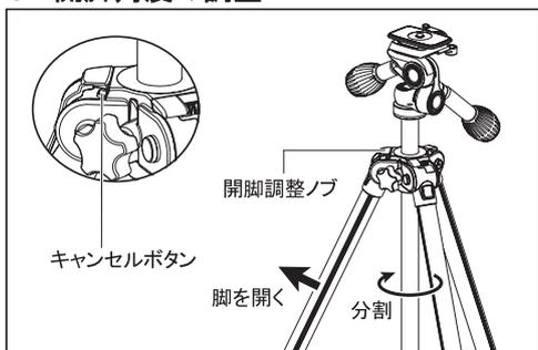
脚を閉じた状態で、開脚調整ノブをカチッと止まる位置まで右にスライドさせ、脚をいっばいに開くとローポジションとなります。エレベーターは固定した状態で下部を回すと分割できます。※誤ってノブをスライドさせてしまった場合は、キャンセルボタンを押して元の位置に戻すことができます。
