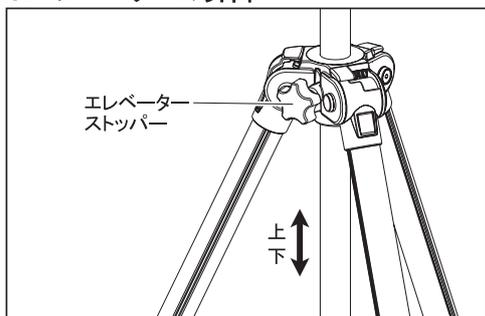
エレベーターストッパーを回して緩めると、エレベーターの昇降ができます。必要な位置でストッパーを締め、固定します。
