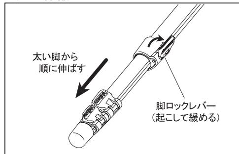
脚を伸ばす時は上の段から順に伸ばします。縮める時は下の段から順にしまってください。脚を最後まで伸ばさないで設置する場合は、できるだけ太い脚を使い、安定性を高めるようにします。
