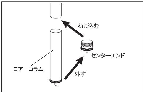
分割したエレベーター下部を、ローアコラムと呼びます。先端に付いているセンターエンドを回して外し、分割部分にねじ込んで「フタ」にすることができます。
