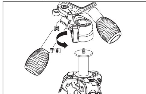
雲台を交換する場合は、各ハンドル棒とストッパー類、及び三脚のエレベーターストッパーをしっかり締め、雲台全体を反時計方向に回して外して下さい。自由雲台など他の別売雲台に交換可能です。
