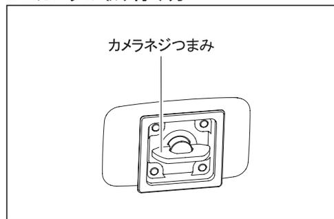
カメラ底面のネジ穴とクイックシューのカメラネジを確実に合わせ、クイックシュー裏面のカメラネジつまみを起こして回し、しっかりと確実に取り付けして下さい。
