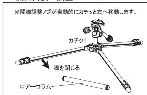
※開脚調整ノブが自動的にカチッと左へ移動します。
