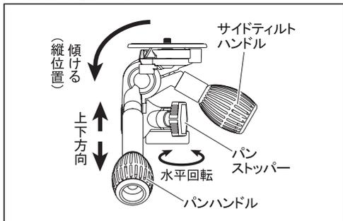
パンハンドルを反時計方向に回し緩めると、カメラの上下方向が変えられます。サイドティルトハンドルを回し緩めると、カメラを縦位置にすることができます。パンストッパーを回し緩めると、カメラを水平回転することができます。構図が決まった位置で各々のストッパーを締め、シャッターをきります。
