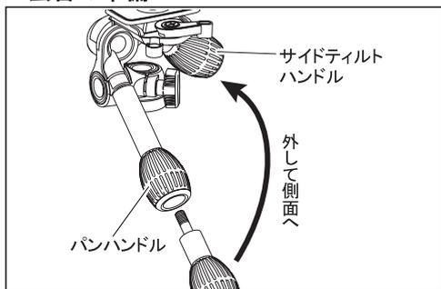
ご購入時は、パンハンドルのグリップにサイドティルトハンドルがねじ込まれています。サイドティルトハンドルを回して外し、側面に取り付けてご使用下さい(ワッシャーを無くさないようご注意ください)。三脚ケースに収納する際は、元のようにハンドルを結合して下さい。
