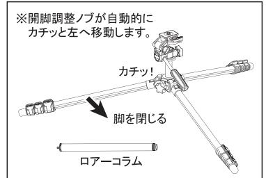
※開脚調整ノブが自動的にカチッと左へ移動します。
