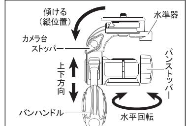
パンハンドルを反時計方向に回し緩めると、カメラの上下方向がえられます。パンストッパーを回し緩めると、カメラを水平回転することができます。カメラ台ストッパーを回し緩めると、カメラを縦位置にできます。
