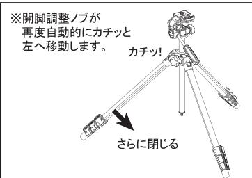
さらに脚を開じていくと、再び開脚調整ノブが自動的にカチッとスライドし、標準開脚に戻ります。
