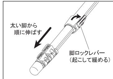
脚の伸縮は脚ロックレバーを起こして脚を引き出し、必要な長さで脚ロックレバーを倒して固定します。脚を全段引き伸ばさないで使用する場合は、できるだけ太い脚を使って撮影して下さい。
