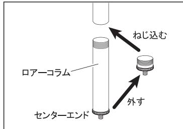
分割したエレベーターの下部をローアコラムと呼びます。先端に付いているセンターエンドを回して外し、分割部分にねじ込み土が入るのを防ぐフタにすることができます。
