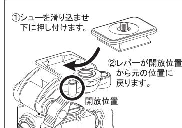
シューフィニッシュレバーを「開放位置」にした状態で、クイックシューをレバー側から斜めに滑らせるように取り付け、下に押し付けるとレバーが戻り半自動固定されます。後は手動でレバーをしっかりと押し込んで下さい。
