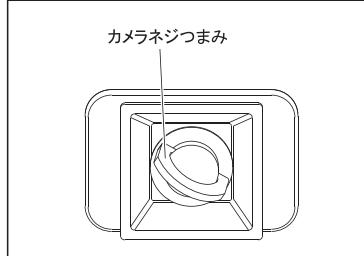
カメラ底面のネジ穴と、クイックシューのカメラネジを確実に合わせ、クイックシュー裏面のカメラネジつまみを起しして回し、しっかりと確実に取り付けて下さい。
