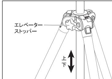
エレベーターストッパーを回し緩めると、エレベーターの昇降ができます。必要な位置でストッパーを締めて固定します。
