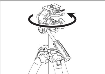
雲台を交換する場合は、パンハンドルやストッパー類、及び三脚のエレベーターストッパーをしっかりと締め、雲台全体を反時計方向に回して外して下さい。自由雲台など他の別売雲台に交換可能です。
