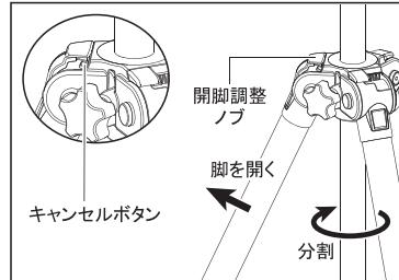
脚を開じた状態で、開脚調整ノブをカチッと止まる位置まで右にスライドさせ、脚をいっぱいに開くとローポジションとなります。エレベーターは固定した状態で下部を回すと分割できます。
