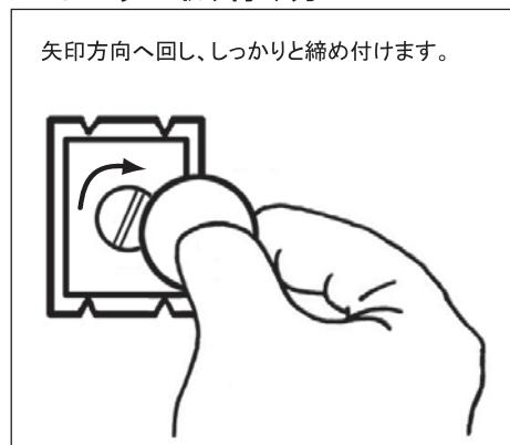
クイックシューのカメラネジを、カメラ底面のネジ穴に確実に合わせ、裏側からコイン等で上図矢印方向へ回し、しっかりと取り付けます。
