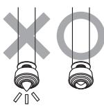
三脚には、推奨積載質量が設定されています。必ずその範囲内のカメラを使用して下さい。特に雲台が付いた三脚自重の2倍を超えるカメラを使用すると、安定性が極端に悪くなりますのでご注意下さい。三脚が転倒し死亡や大ケガにつながる恐れがあります。またカメラブレの原因にもなります。
