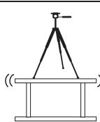
三脚や一脚は、金属部品やカーボン繊維で構成されており、通電します。高压線など電気が通っている物の近くでは使用を避けて下さい。また落雷の恐れがある場合は、絶対に使用しないで下さい。そのような場所では撮影を止め、速やかに避難してください。
