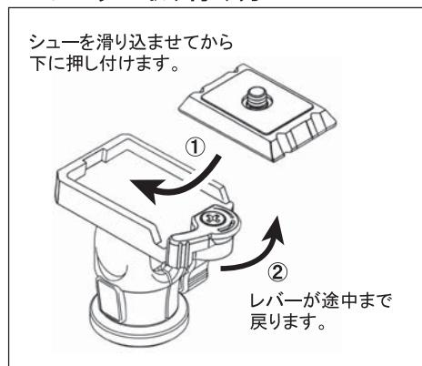
ショーフィットを開放位置にした状態で、クイックシューをレバー側から斜めに滑らせるように取り付け、下に押し付けるとレバーが途中まで戻りますので、さらに手動でレバーを最後まで押し込み、クイックシューを確実に固定してください。
