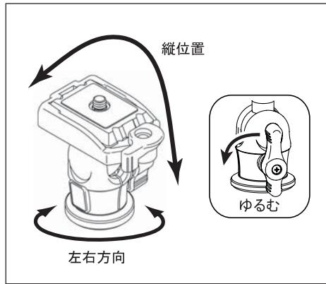
ストッパーをゆるめるると、上図矢印方向へカメラが自由に動きります。構図が決まった位置でストッパーをしめて固定し、撮影します。
