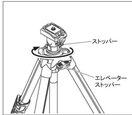
三脚への取り付けは、雲台のストッパーと三脚のエレベーターストッパーを確実にしめてからおこなってください。三脚の雲台取付ネジと、雲台底面の取付ネジ穴を確実に合わせ、雲台全体を時計方向にゆっくりと回し、しっかりと固定します。
