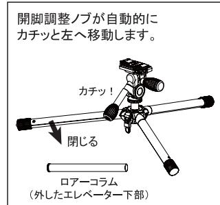
開脚調整ノブが自動的にカチッと左へ移動します。
