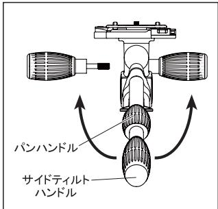
パンハンドル後ろに結合しているサイドティルトハンドルを回してはずし、雲台側面の穴に時計方向へねじ込み取り付けます。左右どちらにも取り付け可能です。ケース収納時は、はずして元のようにパンハンドル後ろにねじ込んで下さい。
