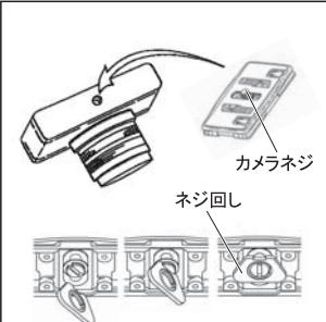
カメラのネジ穴とカメラネジを確実に
