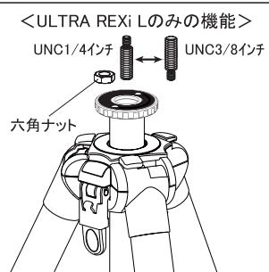
「ウルトラレックスアイエル」は、雲台取付ネジのサイズを、変換することができます。通常UNC1/4(細ネジ)になっていますが、海外メーカー製の雲台を付ける場合は、UNC3/8(太ネジ)にサイズ変換する必要があります。その場合は付属の工具で台座の六角ナットを外し、雲台取付ネジを逆さにしてねじ込みます。その後、六角ナットを元通りに締めこみます。
