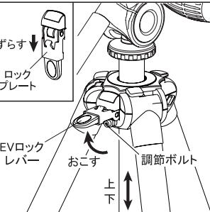
ロックプレートを上図矢印方向へずらしながら、EVロックレバーをおこしてゆるめると、エレベーターの昇降が可能です。必要な位置でレバーを戻してしっかりと固定します。なおEVロックレバーの固さは、調節ボルトを付属の六角レンチで回すと、微調整することができます。
