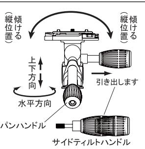
パンハンドルを反時計方向に回しゆるめると、カメラの上下方向と水平方向が同時に変えられます。サイドティルトハンドルをゆるめるると、カメラの傾きが変えられます。サイドティルトハンドルは、撮影時は引っぱって伸ばすと操作性が向上します。持ち運び時は押し込んで縮めれば邪魔になりません。フレームが決まった位置で各ハンドルを確実にしめシャッターをきります。
