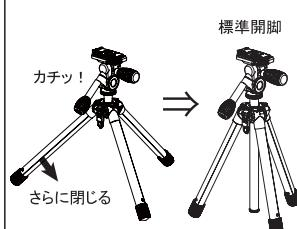
③、さらに脚を閉じていくと、再び開脚調整ノブが自動的にカチッとスライドし標準開脚に戻ります。
