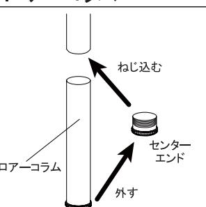
分割したエレベーターハンガー部を「ローアコラム」と呼びます。先端に付いているセンターエンドを回して外し、分割部分にねじ込んで「フタ」にすることができます。ローアコラムは無くさないよう注意して下さい。
