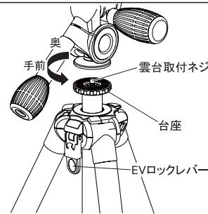
雲台を外す場合は、各ハンドルとEVロックレバーをしっかりと締めて、雲台全体を反時計方向に回して外してください。他の雲台に交換可能です。
