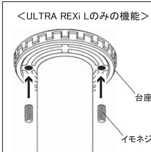
「ウルトラレックスアイエル」には、雲台と三脚の間が緩まないようにするための「雲台固定用イモネジ」が付属しています。台座下側から同梱の六角レンチでねじ込み、雲台底面に突き当てます。
