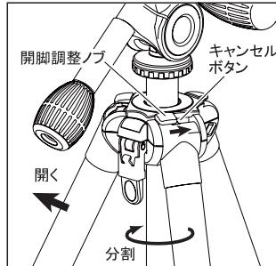
①、脚を閉じた状態で、開脚調整ノブをカチッと止まる位置まで右にスライドさせ、脚をいっぱいに開くとローポジションとなります。エレベーターは固定した状態で下部を回すと分割できます。
