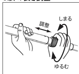
脚の長さを調整するには二段目の調整用グリップを握り、矢印のゆるむ方向に回してから行います。調整し終わったら矢印のしまる方向へキツメに回し、脚を固定します。
