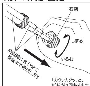
脚を伸ばすには、脚先端の石突を握ってゆるむ方向に「カクッカクッ」と4回抵抗があるまで回します。脚を最後まで引き伸ばし、石突をしまる方向にキツメに回して脚を固定します。脚を縮めるときは逆の手順を行って下さい。
