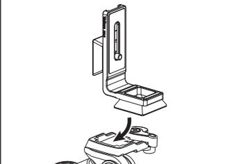
縦位置撮影をするには、プレート垂直部にある縦位置用の取付ベースを使って三脚へ取り付けます。カメラネジは再度しっかりと締めて固定して下さい。
