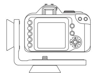
カメラネジは取付ベースごと左右に動きますので、使いやすい位置でカメラを取り付けて下さい(BR-Qはカメラネジのみが動きます)。
