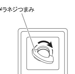
カメラ底面のネジ穴と本製品のカメラネジを慎重に合わせ、カメラネジつまみを起こして回し、しっかりと締め込みます。
