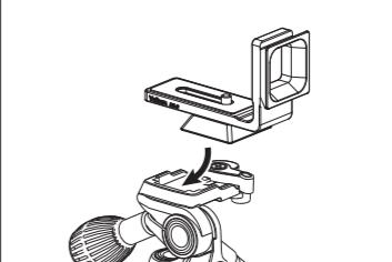
本製品は、三脚のクイックシュークリップの替わりに直接三脚に取り付けます。取り付けの際は、シュー固定レバーが緩んでいないことを必ずご確認下さい。
