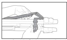
ストラップの反対側を最上段の脚ロックレバー(又は 脚ロックナット)のすぐ上に巻き、バックルをカチンと 音が鳴るまで確実にはめて下さい。
