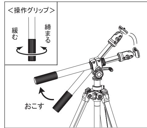
エレベーター下部の「操作グリップ」を、上図緩む方向に回して起こします。エレベーターは上下・左右へ自由に動かすことができますので、位置を決めたら操作グリップを締まる方向へ回してしっかりと固定します。
