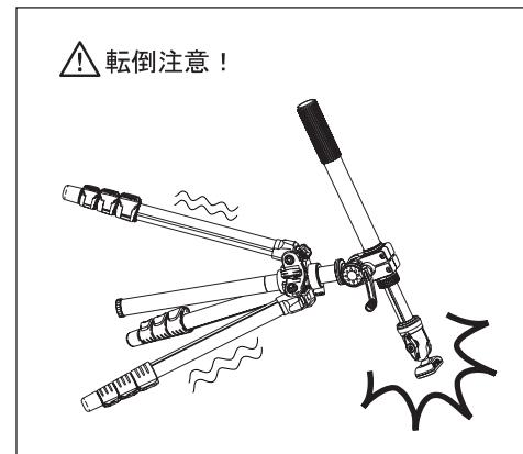
エレベーターの向きによってはバランスが悪くなり、三脚が転倒する恐れがありますので、必ず三脚を押さえながら慎重に操作して下さい。
