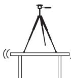
三脚や一脚は、金属部品やカーボン繊維で構成されており、通電します。高压線など電気が通っている物の近くでは使用を避けて下さい。また落雷の恐れがある場合は、絶対に使用しないで下さい。そのような場所では撮影を止め、速やかに避難してください。
