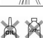
製品に水や砂がついたまま使用を続けると、稼動部から中に入ってしまう故障の原因となります。汚れてしまった場合は、必ずきれいな布でよく拭き取って使用して下さい。脚パイプが濡れてしまった場合は、必ず拭いた後によく乾かして下さい。
