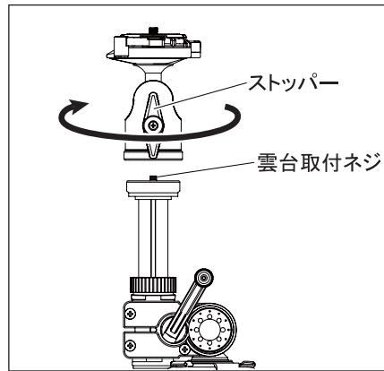
別売雲台を取り付けるには、V4ユニットの操作グリップとエレベータースッパー及び雲台のストッパー類をしっかりと締めて固定し、雲台底面のネジ穴とV4ユニットの雲台取付ネジを確実に合わせ、雲台を上図矢印方向にゆっくり回して、しっかりと取り付けます。
