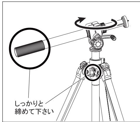
三脚への取り付けは、操作グリップ及び三脚のセンター棒のストッパーを確実に締めてからおこなってください。V4ユニット底面の三脚取付ネジ穴と三脚のネジを確実に合わせ、V4ユニット全体を上図矢印方向にゆっくりと回し、しっかりと固定します。
