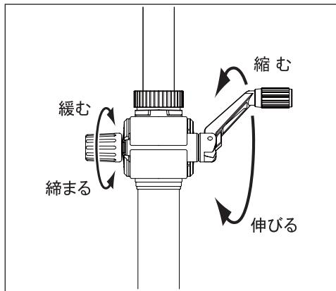
エレベータースッパーを回して緩め、クランクハンドルを回すとエレベーターを伸ばすことができます。必要な位置でストッパーを再び締め、撮影して下さい。
