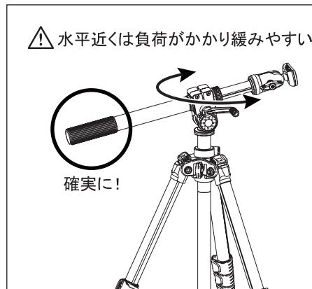
エレベーターを水平に近い角度で使用する場合は、エレベーター中央部が緩まないよう、操作グリップをしっかりと回して確実に固定して下さい。また必ず各ストッパーが緩んでいないことを確認して下さい。
