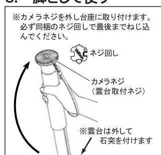
ポール部を外して逆さにしカメラネジ（＝雲台取付ネジ）と石突を取付けることで一脚として使うことができます。事故防止・安定保持のため、上図のように同梱のハンドストラップを取付けて脚部を固定します。縮めるときは逆の手順を行います。
