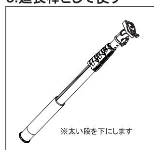
ポール部を外すと、そのまま延長棒として使うことができます。その場合、雲台取付ネジがゆるんでいないか、必ず確認してください。
