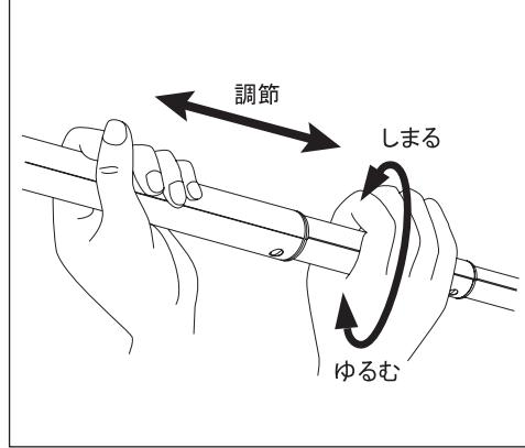
脚の長さを調節するには、下段の脚パイプを上図ゆるむ方向に回してゆるめ、伸縮させます。調節し終わったら、上図矢印のしまる方向へキツメに回し、脚を固定します。
