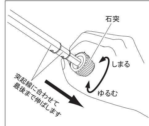
脚を伸ばすには、脚先端の石突を握り、ゆるむ方向に「カクッカクッ」と2回抵抗があるまで回します。脚を最後まで引き伸ばし、石突をしまる方向にキツめに回して脚を固定します。脚を縮めるときは逆手順をおこなって下さい。
