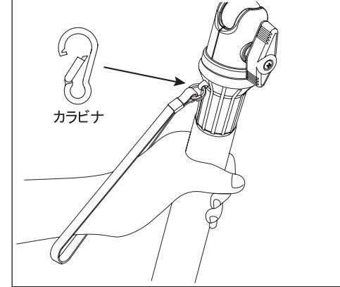
転倒事故防止・安定保持のため、必ず上図のようにリストバンドを手首に通してカメラを支えて下さい。また付属のカラビナで、カメラストラップ等をリストバンドのリングにつないでおくと、不意のカメラ落下の防止になります。
