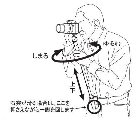
ズボンのベルトにベルトポケットを取り付け、一脚挿し込み穴に一脚先端をしっかりと挿し込みます。左手で雲台を操作し、右手でシャッターを押します。
