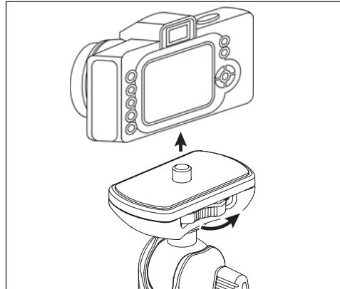
カメラ底面のネジ穴に雲台のカメラネジを合わせ、カメラ固定ツマミを上図矢印方向に回して、しっかりと取り付けます。
