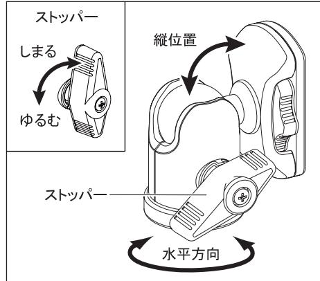
カメラをしっかりと保持しながら、ストップーをゆるめると、カメラを自由に動かすことができます。アングルが決まったらストップーをしまる方向にキツめに回して脚を固定します。
