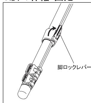
脚の伸縮は脚ロックレバーを起こして脚を引き出し、必要な長さで脚ロックレバーを倒して固定します。脚を全段伸ばさないで使用する場合は、できるだけ太い脚を使って撮影して下さい。
