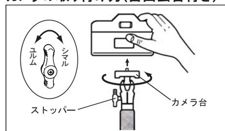
ストッパーを反時計方向に回してゆるめ、カメラ側のネジ穴に一脚のカメラネジを合わせ、カメラ台を上図矢印方向へ回して固定します。
