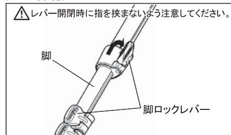
脚の伸縮は、脚ロックレバーを起こして脚を引き出し、必要な長さで脚ロックレバーを倒して固定します。脚を全段引き伸ばさないで撮影する場合は、できるだけ上段の太い脚を使って撮影してください。
