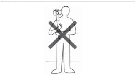
撮影場所の移動などの際は、必ず雲台からカメラを外して携帯してください。カメラを取り付けたまま携帯すると、予想以上の力が加わりカメラが落下・破損する恐れがあります。
