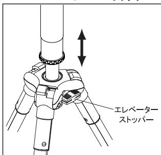
エレベーターストッパーを回してゆるめ、手動で高さを調整します。必要な高さでエレベーターストッパーを締めて固定してください
