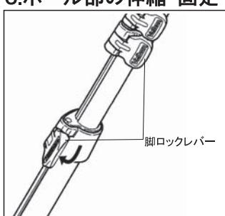
ポール部の伸縮は、脚ロックレバーを起こして脚を引き出し、必要な長さで脚ロックレバーを倒して固定します。ポール部を全段引き伸ばさないで使用する場合は、できるだけ太い脚を使つて撮影してください。
