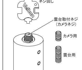
Pole Podは、雲台取付ネジが長短2種類あります(工場出荷時は長ネジ)。使用状況により、適切な取付けネジをお使いください。
