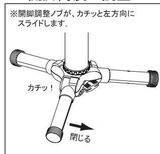
ローポジション(上図イラスト)にした脚をゆっくり閉じていくと、開脚調整ノブが自動的にカチッと左方向へスライドします。この位置がセミロー位置となります。
