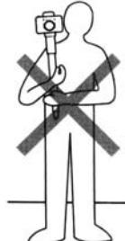
撮影場所などの移動の際は、必ずカメラを外して携帯してください。カメラを付けたまま移動すると予想以上の力が加わり、カメラが落下する恐れがあります。
