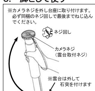
ポール部を外して逆さにしカメラネジ(=雲台取付ネジ)と石突を取付けることで一脚として使うことができます。事故防止・安定保持のため、上図のように同梱のハンドストラップを取り付け手首に通してカメラを支えて下さい。※一脚の台座に雲台を取り付ける場合は
