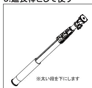
ポール部を外すと、そのまま延長棒として使うことができます。その場合、雲台取付ネジがゆるんでいないか、必ず確認してください。※一脚の先端にカメラを直接取り付ける場合は、同梱の短ネジをご使用下さい。
