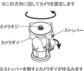
カメラのネジ穴と雲台のカメラネジを合わせ、ストッパーをゆるめてから、カメラダイごと上図矢印方向に回してしっかりと締め付けます。
