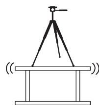
**!** 三脚や一脚は、金属部品やカーボン繊維で構成されており、通電します。高压線など電気が通っている物の近くでは使用を避けて下さい。また落雷の恐れがある場合は、絶対に使用しないで下さい。そのような場所では撮影を止め、速やかに避難してください。
