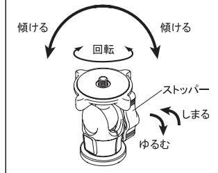
ストッパーをゆるめると、カメラの向きを自由に動かせます。構図が決まったところでストッパーを締めて固定し撮影します。
