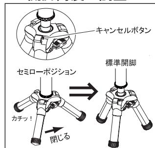
さらに脚を開じていくと、再び開脚調整ノブが自動的にカチッとスライドし標準開脚に戻ります。なお誤ってノブをスライドさせてしまった時は、キャンセルボタンを押すによって元の位置に戻すことができます。
