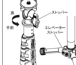
ポール部から雲台を外すには、ストッパー及びエレベーターストッパーをしっかり締め、雲台全体を左回し(上図矢印方向)に回すと外れます。他の雲台を取り付けることが可能です(雲台取付ネジはUNC1/4)。
