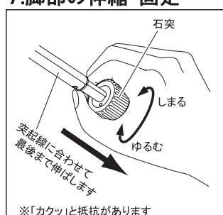
脚部を伸ばすには、脚部先端の石突を握ってゆるむ方向に「カクッ」と抵抗が止まるまで回します。脚を最後まで引き伸ばし、石突を締まる方向にキツメに回して脚部を固定します。縮めるときは逆の手順を行います。
