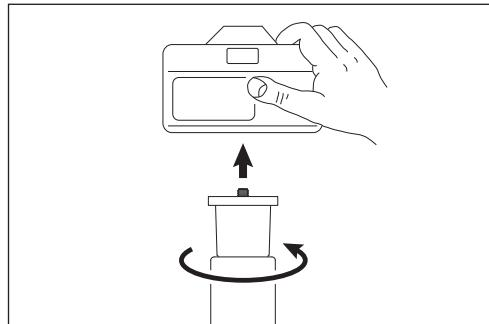
カメラ底面のネジ穴に一脚のカメラネジを合わせ、一脚全体を上図矢印方向に回して、しっかりと固定します。
