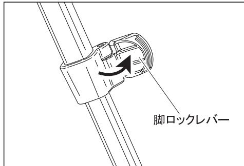
脚の伸縮は、脚ロックレバーを起こして脚を引出し必要な長さで脚ロックレバーを倒して固定します。脚を全段引き伸ばさないで使用する場合は、できるだけ太い脚を使って撮影して下さい。
