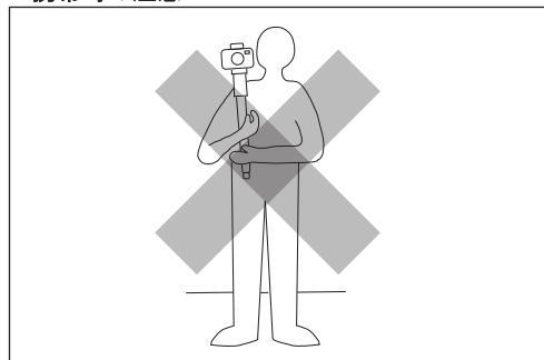
撮影場所の移動などの際は、必ず一脚からカメラを外して携帯してください。カメラを取り付けたまま携帯すると、予想以上の力が加わりカメラが落下・破損する恐れがあります。
