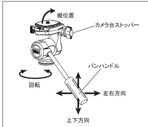
パンハンドルを回しゆるめると、カメラを上下方向・左右方向へ向くことができます。カメラ台ストッパーをゆるめると、カメラを右側へ傾け縦位置にすることができます。フレームが決まった位置で各々を締めつけて固定し、シャッターをきります。
