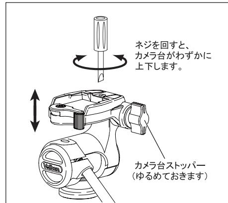
カメラ台は工場出荷時にはほぼ水平に合わせてありますが、必要に応じて微調整が可能です。上記のようにマイナスドライバーでネジを回してください。
