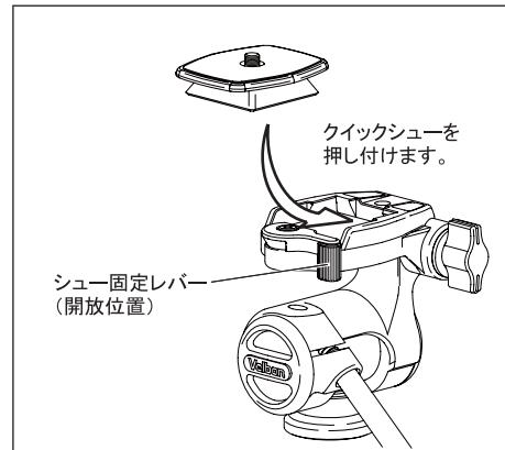
シューフィクシーレバーを開放位置にした状態で、クイックシューをレバー側から斜めに滑らせるように取り付け、下に押し付けるとレバーが途中まで戻りますので、さらに手動でレバーを最後まで押し込み、クイックシューを確実に固定してください。
