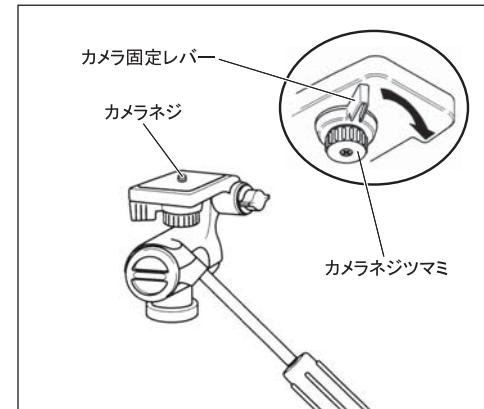
カメラネジをカメラ底面のネジ穴に合わせ、カメラネジツマミを回してしっかりと固定し、最後にカメラ固定レバーを矢印の方向に押し込んで増しジメします(カメラ取付時はハンドル棒やストッパーをしめておこなってください)。
