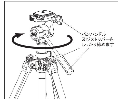
三脚への取り付けは、雲台のハンドルとストッパー及び三脚のエレベーターストッパーを確実にしめてからおこなってください。三脚の雲台取付ネジと、雲台底面の取付ネジ穴を確実に合わせ、雲台全体を時計方向にゆっくりと回し、しっかりと固定します。
