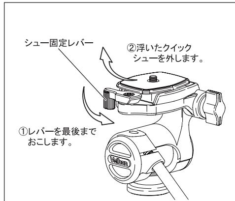
シューフィクシーレバーを最後までおこすと、クイックシューが浮き上りますので、上図矢印方向へスライドさせながら本体からはずします。クイックシューのカメラネジをカメラ底面のネジ穴に合わせ、しっかりと取り付けます。
