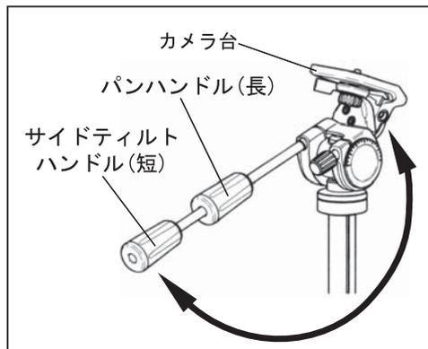
① サイドティルトハンドルをパンハンドルから外し、カメラダイ側面に取り付けてご使用ください。収納するなどの際には、元のようにサイドティルトハンドルをパンハンドルにねじ込んで折りたたみます。
