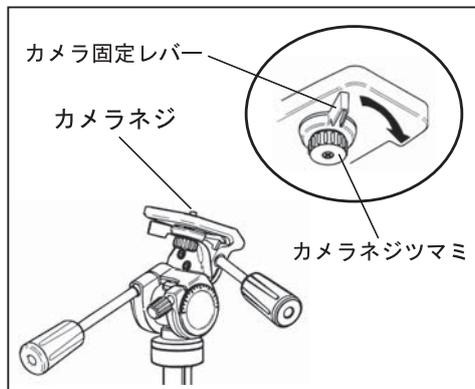
② カメラのネジ穴にカメラネジを合わせ、カメラネジツマミを回してしっかり固定し、最後にカメラ固定レバーを矢印の方向に押し込んで増しジメします（カメラ取付時はハンドル棒やストッパーを締めて行ってください）。
