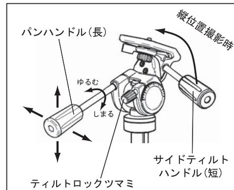
③ パンハンドルを緩めると、雲台の左右と上下の動きが同時に行えます。サイドティルトハンドルを緩めると、カメラの傾きが変わります。必要な位置でハンドルを締めシャッターをきります。※ティルトロックツマミを締めると、雲台の上下の動きのみ固定されます。
