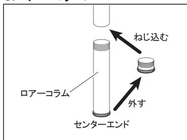
分割したエレベーターの下部をローアコラムと呼びます。先端に付いているセンターエンドを回して外し、分割部分にねじ込み土が入るのを防ぐことができます。
