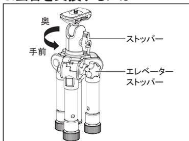
雲台を交換する場合は、雲台のストッパー及び三脚のエレベーターストップパーをしっかりと締め、雲台全体を反時計方向に回して外して下さい。他の別売雲台に交換可能です。
