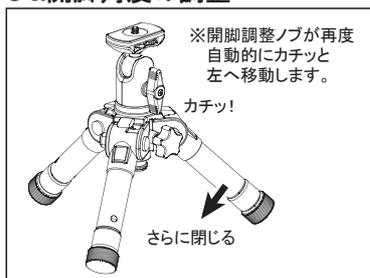
さらに脚を閉じていくと、再び開脚調整ノブが自動的にカチッとスライドし、標準開脚に戻ります。
