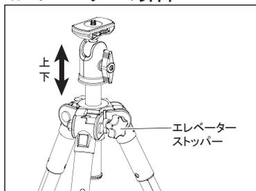
エレベーターストップパーを回し緩めると、エレベーターの昇降ができます。必要な位置でストッパーを締めて固定します。
