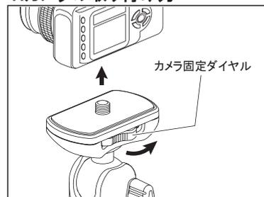
カメラ底面のネジ穴に、雲台のカメラネジを合わせ、カメラ固定ダイヤルを上図矢印方向に回して、しっかりと取り付けます。
