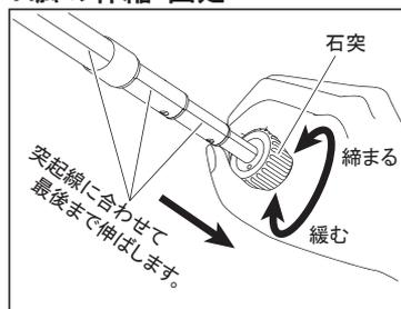
脚を伸ばすには、脚先端の石突を握り、緩む方向に「カクカク」と段数の節目分の抵抗が止まるまで一気に回します。脚を最後まで引き伸ばしたら、石突を締める方向にきつめに回し固定します。脚を縮める際は、逆の手順をおこなってください。
