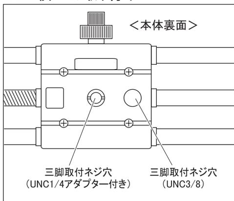
本体裏面には、三脚取付ネジ穴が2ヶ所あります。中央にはUNC1/4サイズ(細ネジ)のアダプターがねじ込まれており、もう一方はUNC3/8サイズ(太ネジ)のネジ穴が開いています。
