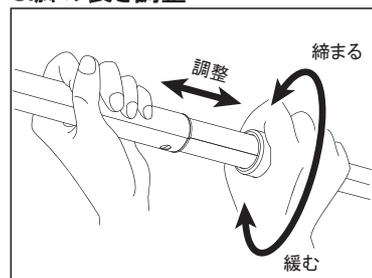
脚の長さを調整するには、二段目の調整用グリップを握り、緩む方向に回して伸縮調整します。調整後は締める方向へきつめに回し、脚を固定します。
