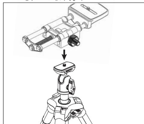
本体裏面の三脚取付ネジ穴と、三脚側のネジを確実に合わせ、しっかりと取り付けて下さい。
