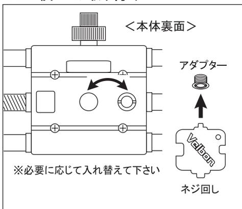
UNC1/4サイズ(細ネジ)アダプターは、付属のネジ回しで回すと外れます。外した際はもう一方のUNC3/8サイズのネジ穴にねじ込むことができます。三脚のカメラネジ位置により、重心ができるだけ中央になる様バランスの良い方のネジ穴をお選び下さい。
