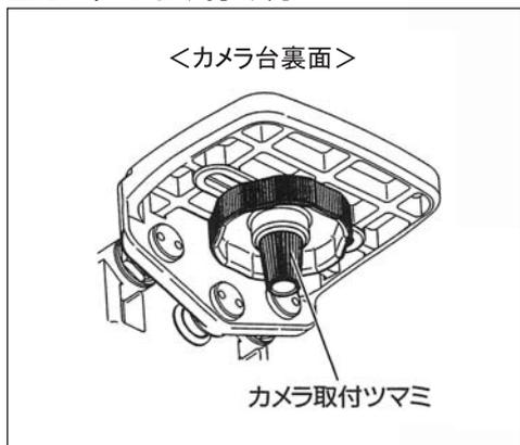
カメラ底面のネジ穴とカメラネジを確実に合わせ、カメラ取付つまみを回してしっかりと固定して下さい。
