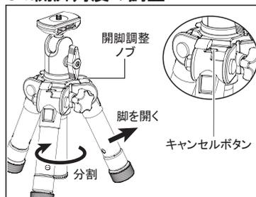
脚を閉じた状態で、開脚調整ノブをカチッと止まる位置まで右にスライドさせ、脚をいっばいに開くとローポジションとなります。エレベーターは固定した状態で下部を回すと分割できます。
