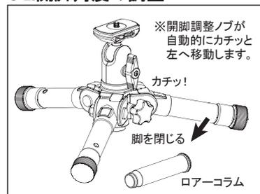
※開脚調整ノブが自動的にカチッと左へ移動します。
