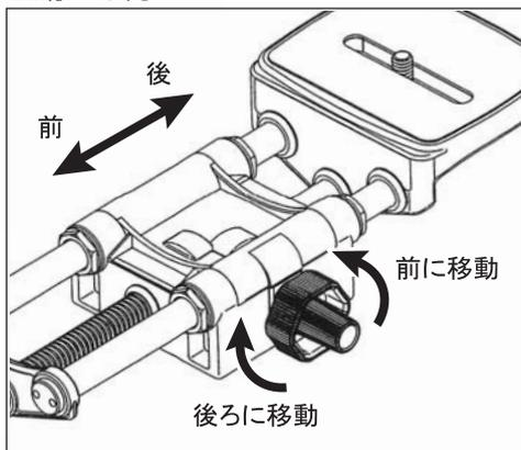
前後スライドつまみを回すとカメラ台が前後方向に微動します。つまみは1回転で4mm移動し、離すとその位置でカメラ台が固定されます。精密な動きでマクロ撮影などのピント合わせが快適におこなえます。
