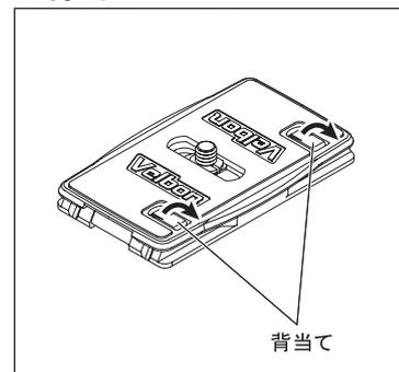
背当てをおこすと、カメラ縦位置時のレンズ重さによる「前倒れ」を、防ぐことができます。背当ては、カメラネジ位置を移動させて、カメラ背面にうまく合わせて下さい。※カメラ背面の形状によっては機能しないことがあります。
