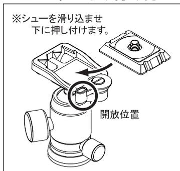
シュー固定レバーを開放位置にした状態で、クイックシューをレバー側から斜めに滑らせるように取り付け、下に押し付けるとレバーが戻り半自動固定されます。さらに指でレバーを押し込み、確実に固定してください。
