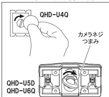
カメラ底面のネジ穴に、クイックシューのカメラネジを合わせ、QHD-U4Qは裏側からコイン等で上図矢印方向へ回し、QHD-U5D/U6Qはカメラネジつまみを起こして回し、しっかりと確実に締め付けます。
