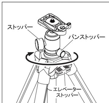
三脚への取付けは、雲台のストッパー類及び三脚のエレベーターストッパーを確実に締めてからおこなってください。三脚の雲台取付ネジと雲台底面の取付ネジ穴を確実に合わせ、雲台全体を時計方向にゆっくり回ししっかり固定します。
