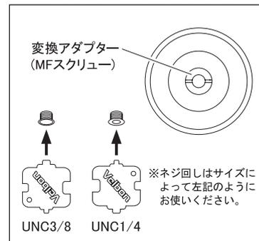
雲台の三脚取付ネジ穴は、ご購入時はUNC1/4インチ(細ネジ)用となっておりますが、QHD-U5D/U6Qの2機種については同梱の変換アダプターにより、UNC3/8(太ネジ)の三脚に取り付けることが可能です。付属のネジ回しやコイン等で、アダプターを交換して下さい。
