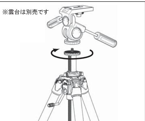
別売の雲台を取り付けるには、雲台のストッパーとハンドル棒をしっかりと締め、雲台を上図の矢印方向に回して取り付けます。取り付ける雲台には三脚取り付けネジ穴のサイズが、UNC3/8(太ネジ用)のものをお選びください。
