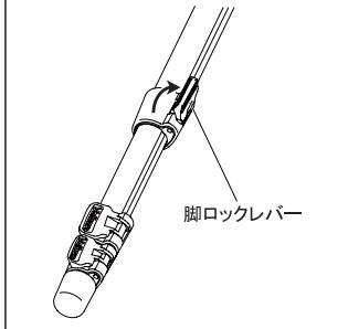
脚の伸縮は脚ロックレバーを起こして脚を引き出し、必要な長さで脚ロックレバーを倒して固定します。脚を全段伸ばさないで使用する場合は、できるだけ太い脚を使って撮影して下さい。
