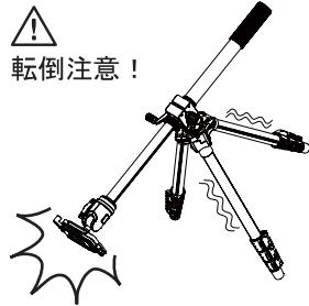
エレベーターの向きによってはバランスが悪くなり、三脚が転倒する恐れがありますので、必ず三脚を押さえながら慎重に操作して下さい。
