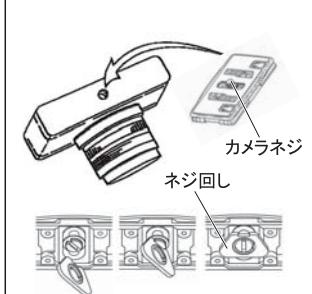
カメラのネジ穴とカメラネジを確実に
