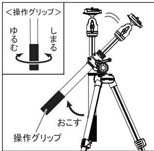
エレベーター下部の「操作グリップ」を上図ゆるむ方向に回して起こします。エレベーターの伸びる方向を決めたら同じ方向に回してしっかりと固定します。
