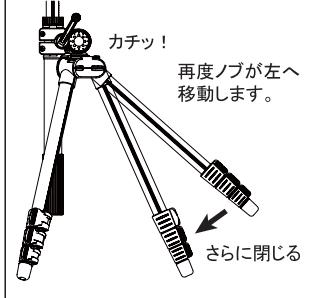
③、さらに脚を閉じていくと、再び開脚調整ノブが自動的にカチッとスライドし、標準開脚に戻ります。なお開脚角度は各々の脚で設定することができます。不整地などで三脚を使う場合にも有効です。
