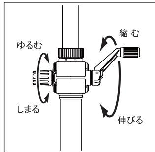
エレベーターストッパーを回してゆるめ、クランクハンドルを回すとエレベーターを伸ばすことができます。必要な位置でストッパーを再びしめ、撮影して下さい。
