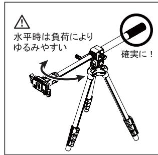
エレベーターを水平に近い角度で使用する場合は、エレベーター中央部がゆるまないよう、操作グリップをしっかりと回して確実に固定して下さい。又必ず各ストッパーがゆるんでいないことを確認して下さい。
