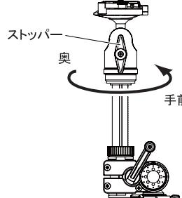
雲台を外す場合は、ストッパーを確実にしめ、雲台全体を反時計方向に回して外して下さい。他の雲台に交換可能です。
