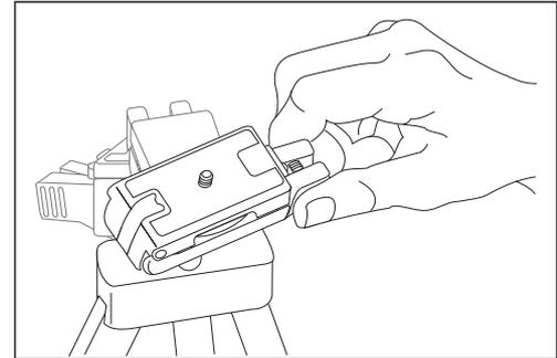
ストップ解除レバーをつまむと、カメラの向きを自由に変えることができます。つまみを放すと向きが固定されます。
