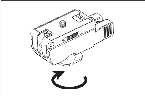
雲台全体を上図矢印方向に回して取り付けます。
