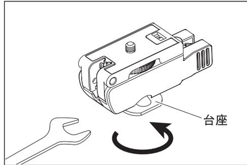
雲台が外れなくなってしまった場合は、付属のスパナで台座部分を矢印方向に回して外します。
