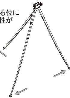
脚が最後まで引き出されていない状態で設置すると、脚が沈んで転倒の恐れがあります。必ず最後まで脚を引き出し、三脚から手を離す前に確認して下さい。
