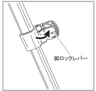
脚の伸縮は、脚ロックレバーを起こして脚を引出し、必要な長さで脚ロックレバーを倒して固定します。脚を全段引伸ばさないで使用する場合は、できるだけ太い脚を使って撮影して下さい。
