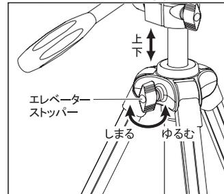
エレベーターストッパーをゆるめ、手でエレベーター高さを調整して下さい。必要な位置でエレベーターストッパーをして固定します。
