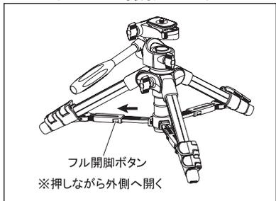
ローポジション機能のある三脚では、フル開脚ボタンを両側から押しながら脚を外側へ開くと、雲台位置がさらに低くなり、ローポジション撮影が可能です。※戻す際はそのまま脚を閉じて下さい。
