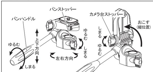
パンハンドルを反時計方向に回しゆるめると、カメラを上下方向に向けることができます。パンストッパーをゆるめると、カメラを左右方向へ回転させることができます。カメラ台ストッパーをゆるめると、カメラを縦位置にすることができます。構図が決まった位置で各ハンドル・ストッパーを確実にしめて撮影して下さい。
