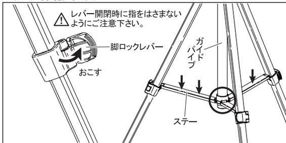
脚の伸縮は脚ロックレバーをおこして脚を引き出し、必要な長さで脚ロックレバーを倒して固定します。脚を全段引き伸ばさないで使用する場合は、できるだけ太い脚を使って撮影して下さい。なお、開脚時は中央のステイ付け根がガイドパイプの下端に届くまで、確実に開いて下さい。下端に届いていない場合は、ステイを上から手で押し下げて届かせて下さい。
