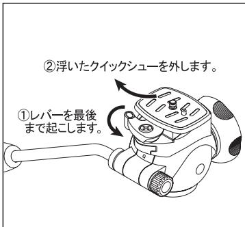
「ショーフィニッシュレバー」を最後まで起こすと、クイックシューが浮き上がりますので、上図矢印方向へスライドさせながら、本体から外します。
