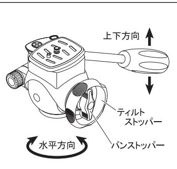
ティルトストッパーを回し緩めると、カメラの上下方向が変えられます。パンストッパーを回し緩めると、カメラを水平回転することができます。
