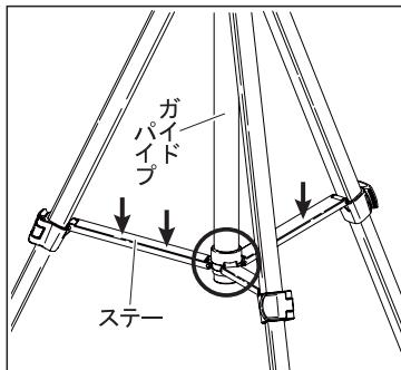
開脚時は、中央のステー付け根がガイドパイプの下端に届くまで、確実に開いて下さい。下端に届いていない場合は、ステーを上から手で押し下げて、届かせて下さい。
