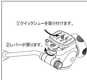
ショーフィニッシュレバーを開放位置にした状態でクイックシューをレバー側から斜めに滑らせるように取り付け、下に押し付けるとレバーが戻ります(クイックシューは縦・横どちら向きでも取り付け可能ですが)。ショーフィニッシュレバーが最後まで締まっていない場合は、指で押し込んで下さい。
