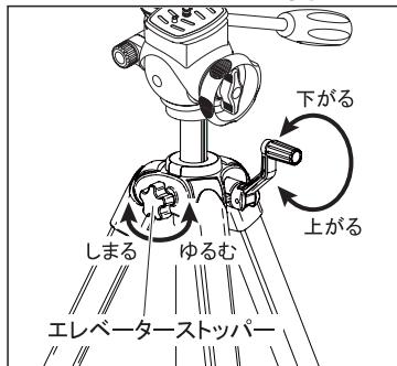
エレベーターストッパーをゆるめ、クランクハンドルを回すとエレベーターの昇降ができます。必要な高さでエレベーターストッパーをしめて固定します(エレベーター操作は、必ず機材に手を添えながらおこなって下さい)。
