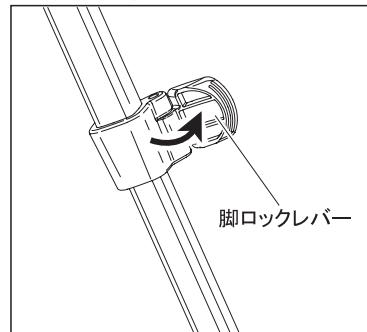
脚の伸縮は、脚ロックレバーを起こして脚を引き出し、必要な長さで脚ロックレバーを倒して固定します。脚を全段引き伸ばさないで使用する場合は、できるだけ太い脚を使って撮影して下さい。
