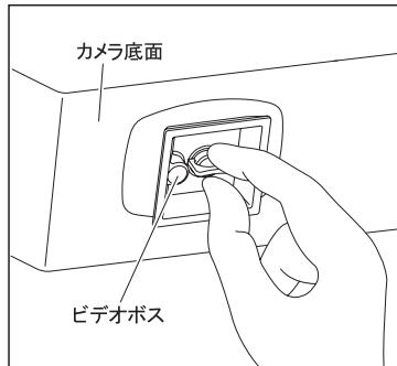
カメラ底面のネジ穴とクイックシューのカメラネジを確実に合わせ、クイックシュー裏面のつまみを回し、しっかりと確実に取り付けて下さい。ビデオカメラに取り付ける場合はビデオボスの位置を合わせて下さい。
