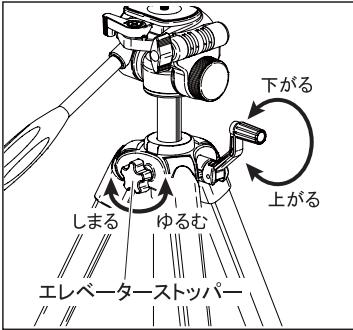
エレベーターストッパーをゆるめ、クランクハンドルを回すとエレベーターの昇降ができます。必要な高さでエレベーターストッパーをしめて固定します(エレベーター操作は、必ず機材に手を添えながらおこなって下さい)。
