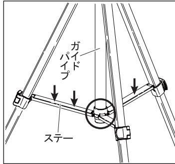
開脚時は、中央のステー付け根がガイドパイプの下端に届くまで、確実に開いて下さい。下端に届いていない場合は、ステーを上から手で押し下げて、届かせて下さい。
