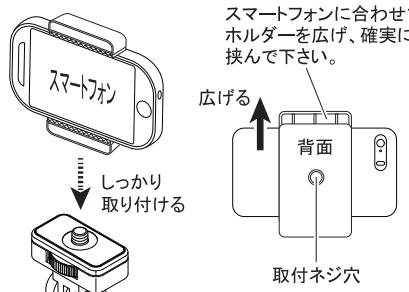
スマートフォンを使って撮影する場合は、同梱のスマートフォンホルダーをカメラネジにしっかりと取り付けて下さい。取付用のネジ穴はホルダーの底面および背面にありますので、状況に応じてお選び下さい。必ず、スマートフォンが確実に取り付けられていることを確認してご使用下さい。
