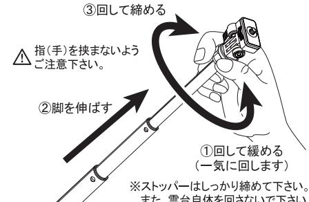
脚を伸ばすには、雲台のストッパーをしっかりと締めて固定し、雲台下部の「台座」を握って、緩む方向に「カクッカクッ」と5回の抵抗があるまで一気に回します。脚を最後まで引き伸ばしたら、今度は「台座」を締まる方向にキツめに回して脚を固定します。縮めるときは逆の手順をおこなって下さい。
