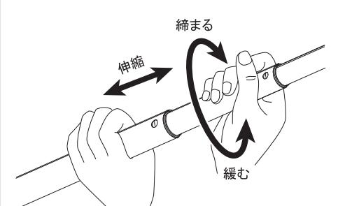
脚の長さを調整するには両手で脚関節を挟んでしっかりと握り、上図矢印の緩む方向に回してから伸縮させます。調整が終わったら上図矢印の締まる方向へキツめに回し、脚を固定します。
