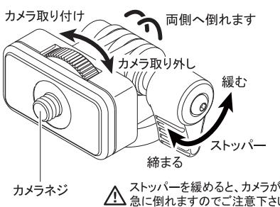
カメラのネジ穴にカメラネジを確実に合わせ、ダイヤルを回してカメラをしっかりと取り付けて下さい。雲台のストッパーを上図矢印方向に緩めると、カメラを前後両側へ倒すことができます。構図が決まった位置でストッパーをしっかりと締め、撮影します。
