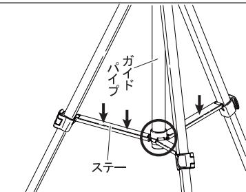
開脚時は、中央のステー付け根がガイドパイプの下端に届くまで、確実に開いて下さい。下端に届いていない場合は、ステーを上から手で押しつけて届かせて下さい。
