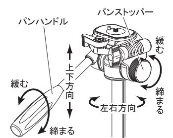
パンハンドルを反時計方向に回し緩めると、カメラの上下方向が変えられます。パンストッパーを緩めると、カメラを左右方向へ回転させることができます。
