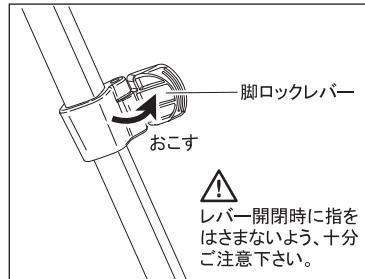
脚の伸縮は、脚ロックレバーを起こして脚を引き出し、必要な長さで脚ロックレバーを倒して固定します。脚を全段引伸ばさないで使用する場合は、できるだけ太い脚を使って撮影して下さい。
