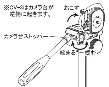
※CV-3はカメラ台が逆側に起きます。カメラ台ストッパーを緩めると、カメラの傾きが変えられます。フレームが決まった位置でハンドル棒とストッパーを確実にしめ、シャッターをきります。
