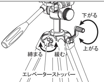
エレベーターストッパーを緩めクランクハンドルを回すとエレベーターの昇降ができます。必要な高さでエレベーターストッパーを締めて固定します。
