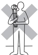
**!** 各部ストッパーネジやハンドル棒・固定レバー等は、必要なとき以外は確実に締めてご使用下さい。ネジやレバーが緩んでいると、三脚の転倒やカメラ破損の原因となります。また、緩んだ状態で移動すると、ネジ等を落として紛失する可能性があります。
