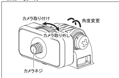
カメラ底面のネジ穴に本製品のカメラネジを確実に合わせ、ダイヤルを回してカメラをしっかりと取り付けて下さい。カメラを前後へ傾げると、カメラ台の角度を変えることができます。
