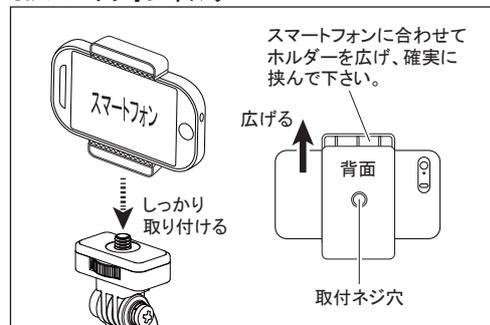
スマートフォンを使って撮影する場合は、同梱のスマートフォンホルダーをカメラネジにしっかりと取り付けて下さい。取付用のネジ穴はホルダーの底面および背面にありますので、状況に応じて選び下さい。
