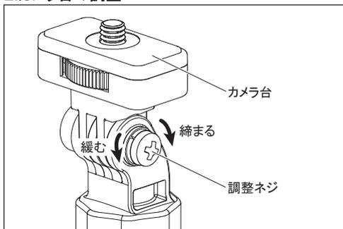
本製品にはカメラ台のストッパーはありません。使用カメラに合わせてカメラ台の動きを調整したい場合は、側面の調整ネジをプラスドライバーで「若干」回して下さい。
