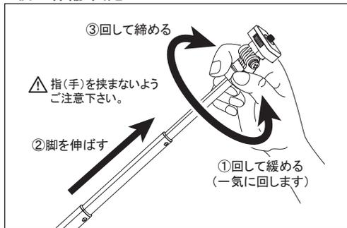
脚を伸ばすには、雲台下部を握って緩む方向に「カックカック」と5回の抵抗があるまで一気に回します。脚を最後まで引き伸ばしたら、今度は雲台下部を締まる方向にキツめに回して脚を固定します。締めるときは逆の手順をおこなって下さい。
