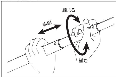
脚の長さを調整するには、両手で脚関節を挟んでしっかりと握り、上図矢印の緩む方向に回してから伸縮させます。調整が終わったら上図矢印の締まる方向へキツめに回し、脚を固定します。
