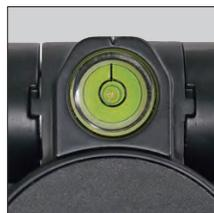
気泡が枠内に入り、水平出し完了。
