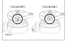
操作中に誤って雲台が緩むことを防ぐための「雲台固定用イモネジ」が付属しています。必要に応じて、アッパーベースの下から同梱の六角レンチでねじ込み、雲台の底面に突き当てて下さい。
