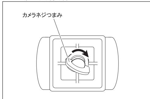
カメラ底面のネジ穴と、クイックシューのカメラネジを確実に合わせ、クイックシュー裏面のカメラネジつまみを起こして回し、しっかりと確実に取り付けてください。
