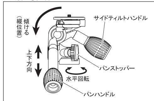
パンハンドルを反時計方向に回し緩めると、カメラの上下方向が変えられます。サイドティルトハンドルを回し緩めると、カメラを縦位置にすることができます。パンストッパーを回し緩めると、カメラを水平回転することができます。構図が決まった位置で各々のストッパーを締め、シャッターをきります。
