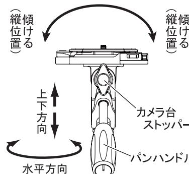
パンハンドルを反時計方向に回しゆるめると、カメラの上下方向と水平方向が同時に変えられます。カメラ台ストッパーをゆるめると、カメラの傾きが変えられます。構図が決まった位置でパンハンドルとカメラ台ストッパーを確実に締め、シャッターをきります。
