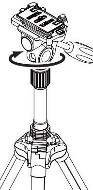
三脚への取り付けは、雲台のパンハンドルとカメラ台ストッパー及び三脚のエレベーターストッパー等を確実にしめてからおこなってください。三脚の雲台取付ネジと、雲台底面の取付ネジ穴を確実に合わせ、雲台全体を時計方向にゆっくりと回し、しっかりと固定します ※適合ネジサイズ(UNC1/4)
