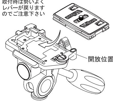
シュー固定レバーを開放位置にした状態で、クイックシューをレバー側から斜めに滑らせるように取り付け、下に押し付けるとレバーが戻り半自動固定されます。後は手動でレバーを最後まで押し込んでください。
