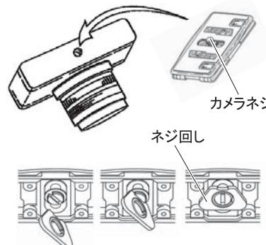
カメラのネジ穴とカメラネジを確実に合わせ、クイックシュー裏面に付いている、ネジ回しでしっかりとしめ付けます（ネジ回しを無くしてしまった場合は、コイン等で代用して下さい）。
