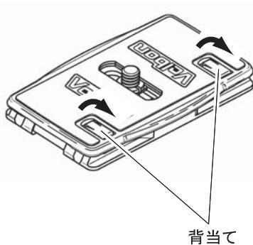
背当てをおこすと、カメラ縦位置時のレンズ重さによる前倒れを防ぐことができます。背当てではカメラネジ位置を移動させて、カメラの背面にうまく合わせてください。
